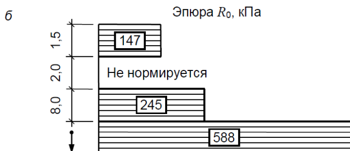
Рисунок 3.1 – Геологическая колонка (а) и эпюра условных сопротивлений (б)
