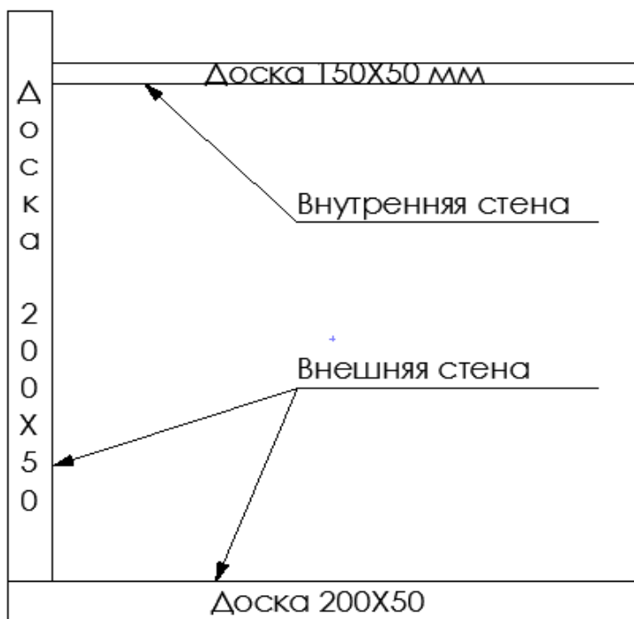
Рисунок 8. Расположение внешних и внутренних стен с сечением обвязок (вид сверху)
