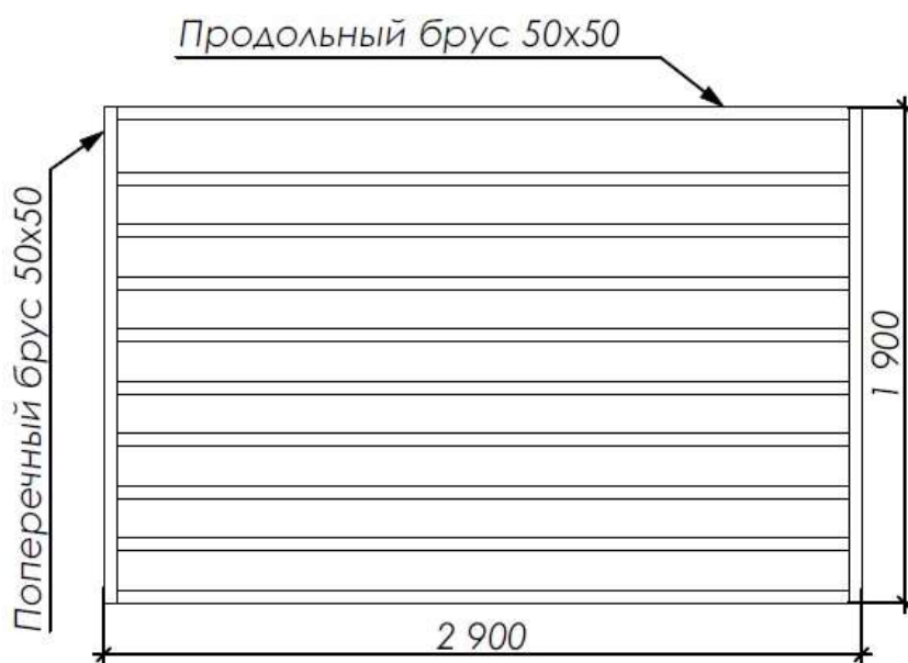
Рисунок 1. Схема раскладки брусьев для формирования напольной клетки
